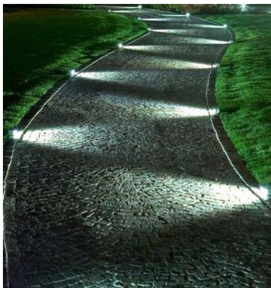
Figura 04.c: Effetto ottico dei marcapassi previsti a quinconce per illuminare il percorso
